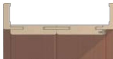
Ościeżnica dla grubości muru powyżej 280 mm składa się z dwóch elementów.
